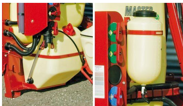
Rezervoar za ispiranje i rezervoar čiste vode
