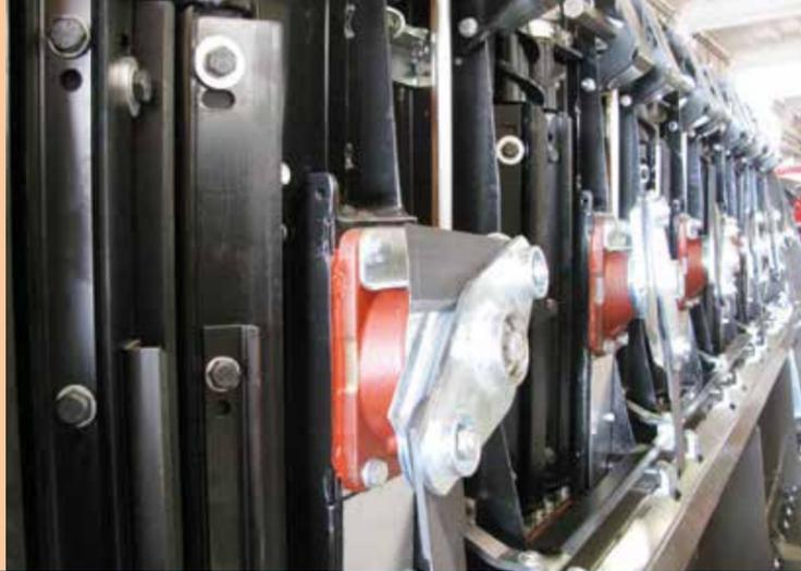
La scatola ad ingranaggi è l'orgoglio del nostro sistema, non usiamo alberi esagonali o scatole di derivazione ma solo una linea diretta semplice ed efficiente di ingranaggi ed alberi. La nostra esecuzione è di grande difficoltà tecnica ma, la costruzione completamente eseguita nella nostra azienda, ci consente di garantire la perfezione del prodotto in ogni componente e consentire al cliente una rapida ed economica manutenzione o riparazione.
