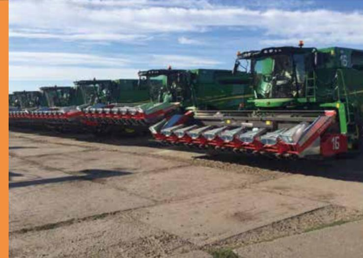
Le testate fisse hanno le trasmissioni in bagno di olio di serie.
