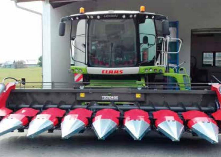
Punte e cofani sono realizzati con un profilo ribassato e sono particolarmente adatte al raccolto dell'allettato; interamente in metallo per una rapida ed economica gestione e manutenzione.
